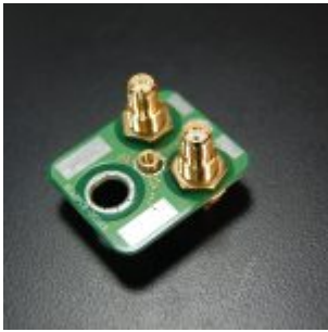
Rear Input Module(CH1/CH2) (U6200-opt04).
